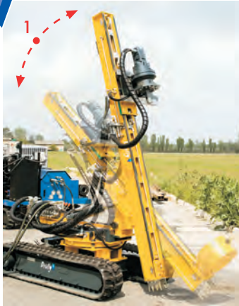
Perforatrice dotata di 7 movimenti (automatici e manuali). / Drilling machine equipped with 7 movements (automatic and manual).
