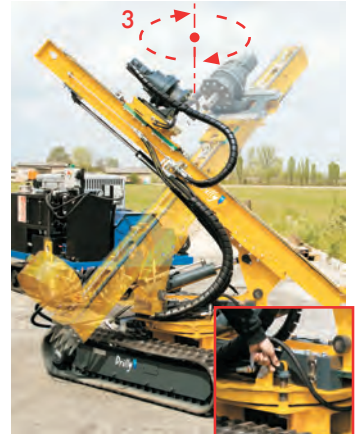
Perforatrice dotata di 7 movimenti (automatici e manuali). / Drilling machine equipped with 7 movements (automatic and manual).
