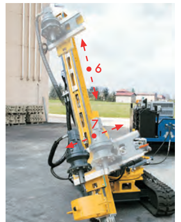
Perforatrice dotata di 7 movimenti (automatici e manuali). / Drilling machine equipped with 7 movements (automatic and manual).
