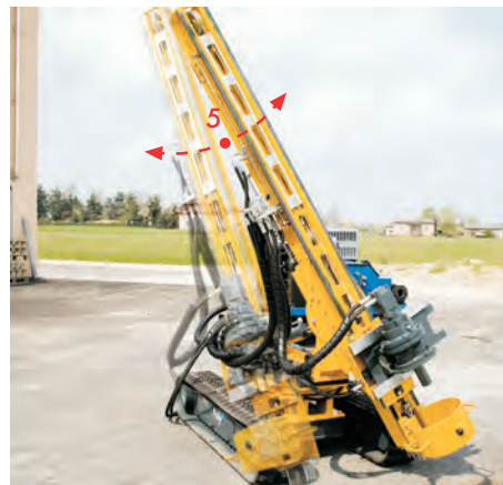
Perforatrice dotata di 7 movimenti (automatici e manuali). / Drilling machine equipped with 7 movements (automatic and manual).
