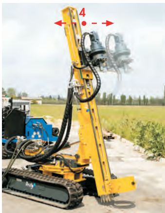
Perforatrice dotata di 7 movimenti (automatici e manuali). / Drilling machine equipped with 7 movements (automatic and manual).
