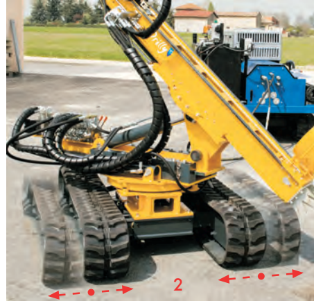
Perforatrice dotata di 7 movimenti (automatici e manuali). / Drilling machine equipped with 7 movements (automatic and manual).
