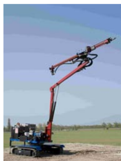
Perforazione orizzontale massima altezza 5300 mm Horizontal drilling maximum height 5300 mm
