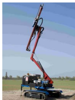
Perforazione verticale massima altezza 2000 mm Vertical drilling maximum height 2000 mm
